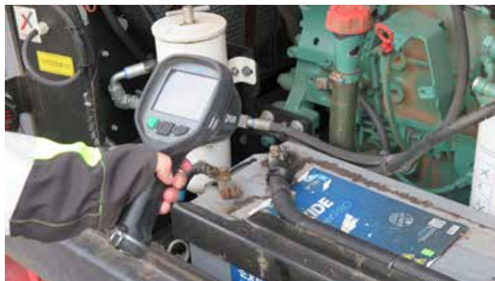
↑ Lämpökamerasta voi olla paljon hyötyä ongelmakohteiden haussa.
